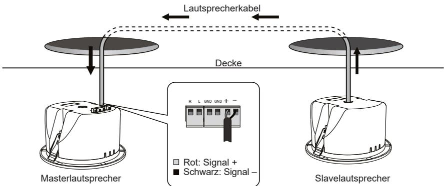
4 – Schließen Sie die Stromversorgung und das vom Slavelautsprecher kommende Lautsprecherkabel am Masterlautsprecher an.
