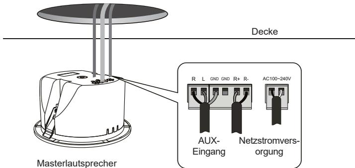
5 – Halten Sie die Federklemmen nach oben gedrückt und schieben Sie den Masterlautsprecher in das Deckenloch. Führen Sie den gleichen Schritt für den Slavelautsprecher durch.
