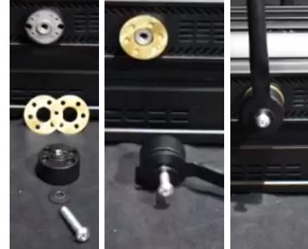
10. Befestigen Sie das Joch auf Zylinder "B" mit der M10-Schraube "H" und einer großen schwarzen Unterlegscheibe aus der Originalhalterung.
