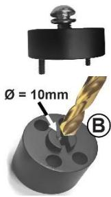
2. Die Zylinder "A" und "B" sind identisch: Nehmen Sie einen von ihnen und vergrößern Sie das Mittelloch mit einem Metallbohrer Ø 10 mm. Ab jetzt nennen wir diesen Zylinder "B"
