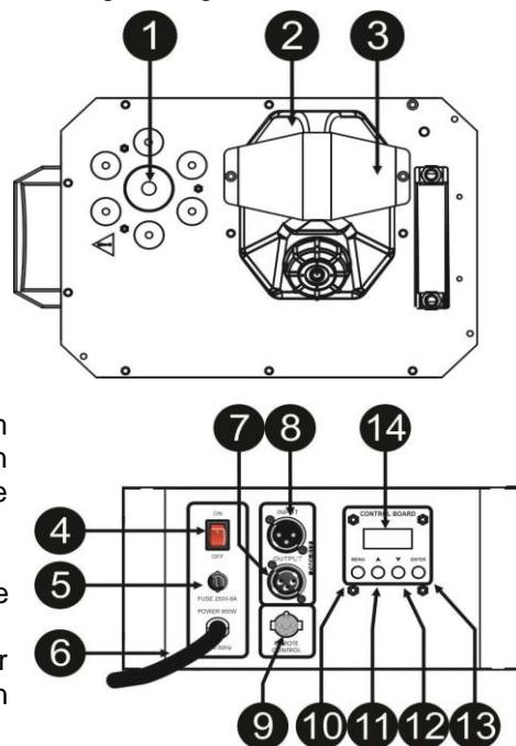
9. **[REMOTE CONTROL] EINGANG:** Dient dem Anschluss des mitgelieferten Drahtlos-Empfängers für die Fernbedienung.
