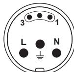
Die Steckverbinder sind mit drei Stiften zur Stromversorgung und drei Stiften für das DMX-Signal ausgestattet. Das Hybridkabel wird für den Teil der Stromversorgung in  $3 \times 1,5 \text{ mm}^2$  und für den isolierten DMX-Teil in einem separaten Mantel verwendet. Der Farocode der entsprechenden Adern ist in der nebenstehenden Abbildung dargestellt.
