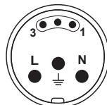
Die Steckverbinder sind mit drei Stiften zur Stromversorgung und drei Stiften für das DMX-Signal ausgestattet. Das Hybridkabel wird für den Teil der Stromversorgung in  $3 \times 1,5 \text{ mm}^2$  und für den isolierten DMX-Teil in einem separaten Mantel verwendet. Der Farocode der entsprechenden Adern ist in der nebenstehenden Abbildung dargestellt.
