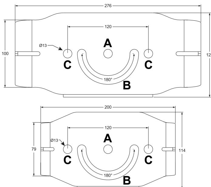
Der Projektor kann mit drei Befestigungspunkten **A** **C** auf einer geeigneten ebenen Fläche befestigt werden. Die Nut **B** dient dazu, die Drehung des Projektors im Schwenk über 180° zu arretieren. Eine vorübergehende Aufhängung ist mit zwei Klemmen möglich, die durch die äußeren Befestigungspunkte **C** geführt werden.
