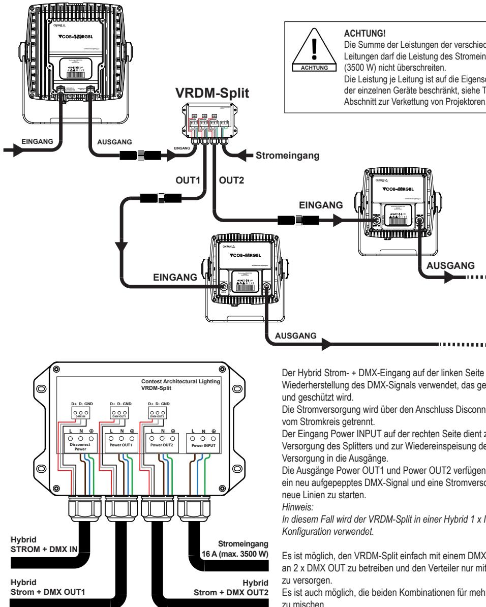
Der Hybrid Strom- + DMX-Eingang auf der linken Seite wird zur Wiederherstellung des DMX-Signals verwendet, das gefiltert, geteilt und geschützt wird.
