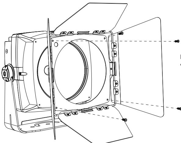
Der Blendschutz gehört zum Lieferumfang. Er wird mit 4 Schrauben an der Vorderseite des Projektors befestigt.
