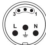
Die Steckverbinder sind mit drei Stiften zur Stromversorgung und drei Stiften für das DMX-Signal ausgestattet. Das Hybridkabel wird für den Teil der Stromversorgung in 3 x 1,5 mm<sup>2</sup> und für den isolierten DMX-Teil in einem separaten Mantel verwendet. Der Farocode der entsprechenden Adern ist in der nebenstehenden Abbildung dargestellt.
