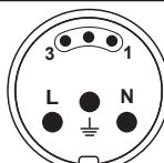
Die Steckverbinder sind mit drei Stiften zur Stromversorgung und drei Stiften für das DMX-Signal ausgestattet. Das Hybridkabel wird für den Teil der Stromversorgung in 3 x 1,5 mm<sup>2</sup> und für den isolierten DMX-Teil in einem separaten Mantel verwendet. Der Farocode der entsprechenden Adern ist in der nebenstehenden Abbildung dargestellt.
